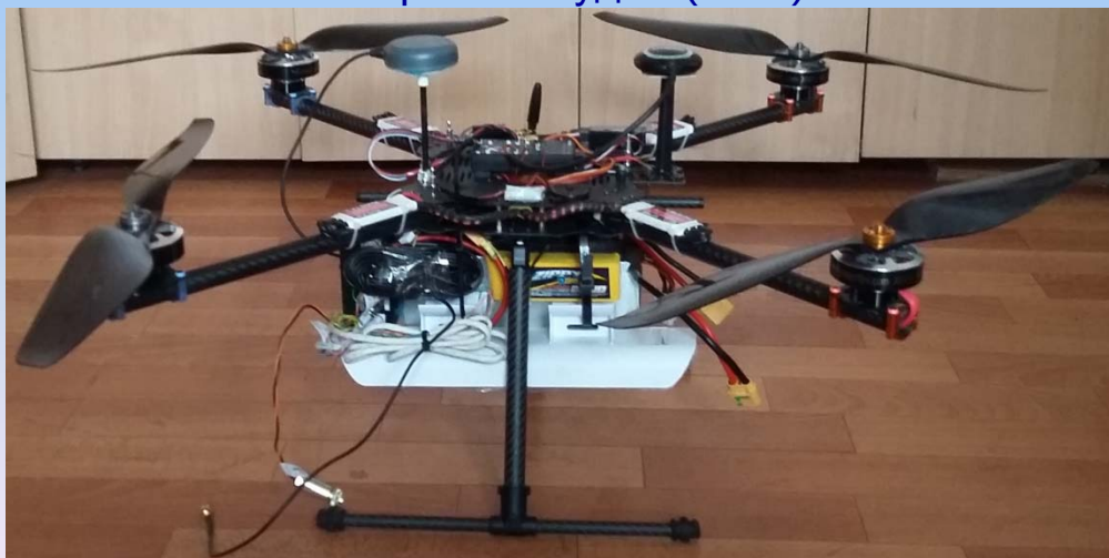
БПС із корисним навантаженням на борту (Raspberry Pi та цифрова камера)
