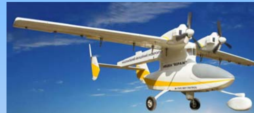
ДВОМОТОРНЕ БЕЗПЛОТНЕ ПОВІТРЯНЕ СУДНО М-7В5 «НЕБЕСНИЙ ПАТРУЛЬ»
